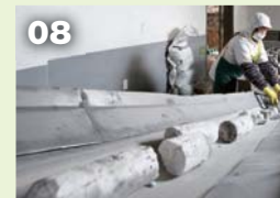
08 소금기둥 분쇄하기 소금기둥에 묻어 있는 대나무와 소나무 재를 제거하고, 분쇄기에 넣어 가루로 만든다. 다시 왕대나무통에 넣고 황토를 발라 무쇠가마에 넣고 굽는다.
