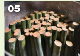
05 무쇠가마에 대나무통 넣기 죽염 제조용으로 특수 고안된 무쇠가마에 황토로 입구를 막은 대나무통을 촘촘히 넣는다.
