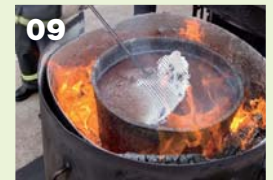
09 고열처리 같은 방식으로 8회 반복해서 구운 죽염을 고열처리 전용로에 넣고 1,600도 이상 고열로 녹인다. 약 40시간 식힌 후 돌처럼 굳은 죽염을 잘게 쪼개 상품화한다.
