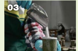
03 대나무통에 소금 넣기 천일염을 골고루 분쇄한 후 공간이 생기지 않도록 단단하게 다져가며 대나무통 속에 넣는다. 고운 입자의 소금은 기계를 이용해 다진다.
